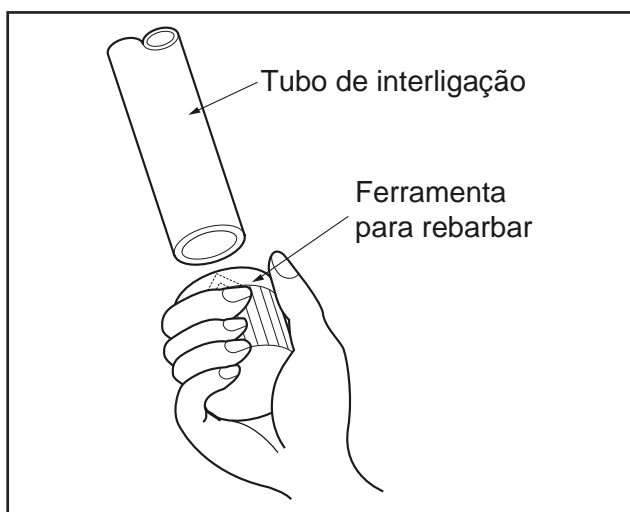
FIG. 34 - FERRAMENTA PARA REBARBAR
